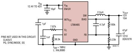
Figure 14. 1MHz 12V, 15A Step-Down Converter
